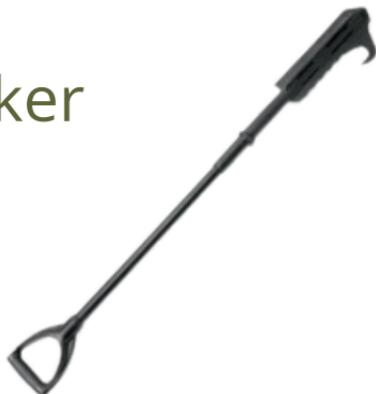
Consta de tres partes: la parte de agarre, el cuerpo de la biela y el dispositivo de rotura de cristales frontales. El sistema de manija en D, eléctricamente no conductor es resistente a 100,000 voltios CA.
